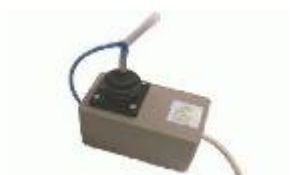
Emulador de ratón con joystick para boca
